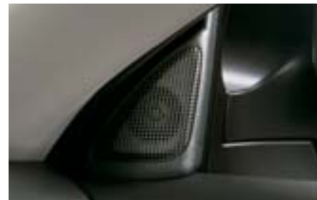
83 Výškové reproduktory – sada H6310FG000 W Speciálně vyvinuté reproduktory zvýrazní vysoké frekvence přehrávaného zvuku. *Pro originální audio soustavu.
