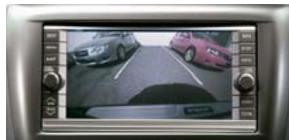
89 Parkovací kamera H0010FG000 W CCD kamera s vysokým rozlišením 250-000 pixelů, která při zařazeném zpětném chodu automaticky zobrazí prostor za vozem na displeji navigace. Má horizontální úhel 183.3° a vertikální úhel 91.6°. *Pouze s navigačním systémem.
